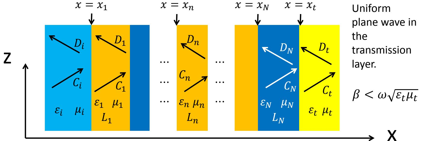
$$\vec{H}_n = e^{j(\omega t - \beta z)} \{C_n e^{-jk_{nx}(x-x_n)} + D_n e^{jk_{nx}(x-x_n)}\} \vec{e}_y$$
