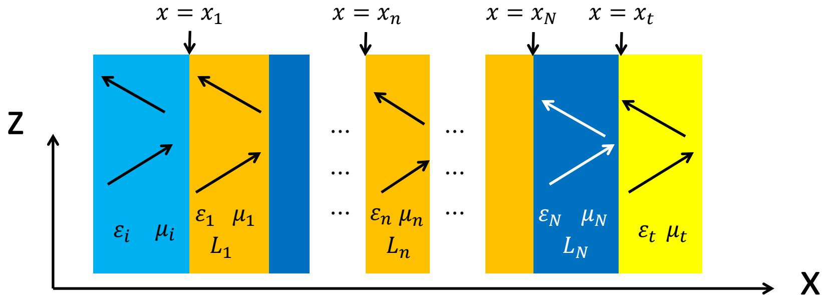
$$\text{TE} \quad \begin{bmatrix} A_t \\ B_t \end{bmatrix} = T_{TE} \begin{bmatrix} A_i \\ B_i \end{bmatrix} \quad T_{TE} = T_N^{TE} T_{N-1}^{TE} \cdots T_n^{TE} \cdots T_2^{TE} T_1^{TE} [(D_1^{TE})^{-1} D_i^{TE}]$$
