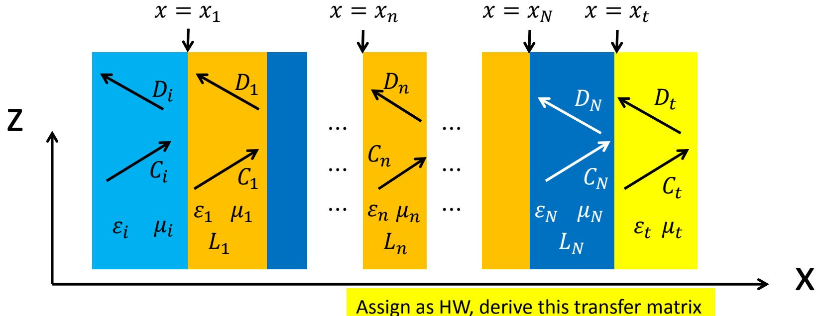
$$\begin{bmatrix} C_t \\ D_t \end{bmatrix} = [(D_t^{TM})^{-1} D_N^{TM} P_N^{TM}] T_{N-1}^{TM} \cdots T_n^{TM} \cdots T_2^{TM} T_1^{TM} \xrightarrow{\text{dashed yellow circle}} \begin{bmatrix} C_i \\ D_i \end{bmatrix}$$
