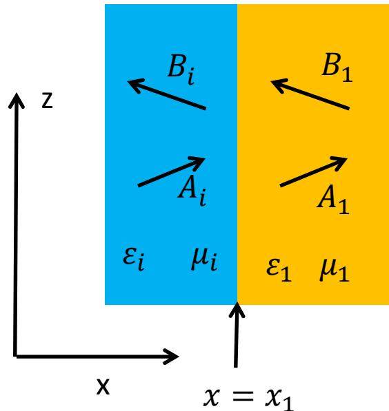
$$\begin{bmatrix} \frac{1}{k_{ix}} & -\frac{1}{k_{ix}} \end{bmatrix} \begin{bmatrix} A_i \\ B_i \end{bmatrix} = \begin{bmatrix} \frac{1}{k_{1x}} & -\frac{1}{k_{1x}} \end{bmatrix} \begin{bmatrix} A_1 \\ B_1 \end{bmatrix}$$
