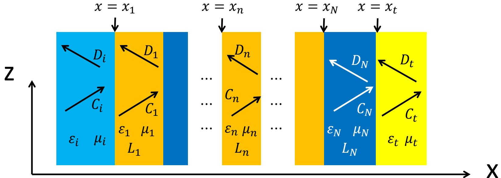
$$\vec{H}_n = e^{j(\omega t - \beta z)} \{ C_n e^{-jk_{nx}(x-x_n)} + D_n e^{jk_{nx}(x-x_n)} \} \vec{e}_y$$
