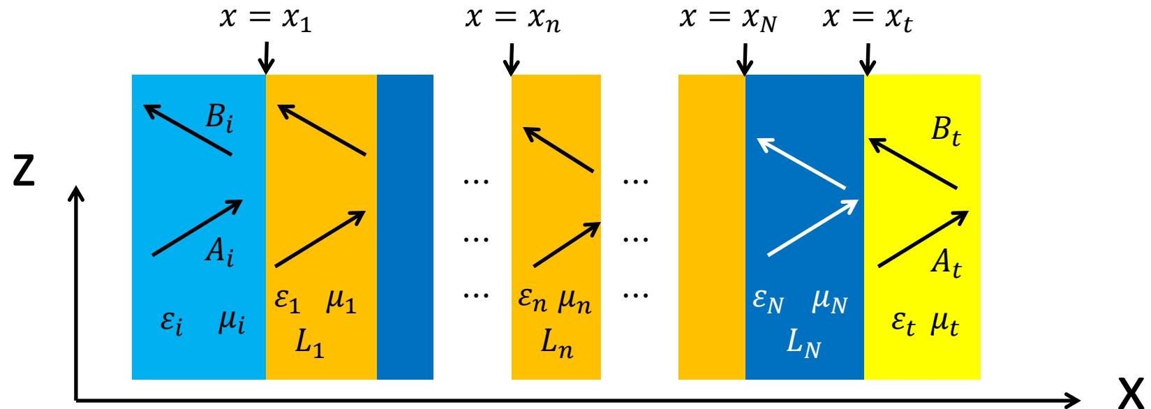
$$\begin{bmatrix} A_t \\ B_t \end{bmatrix} = T_{TE} \begin{bmatrix} A_i \\ B_i \end{bmatrix}$$
