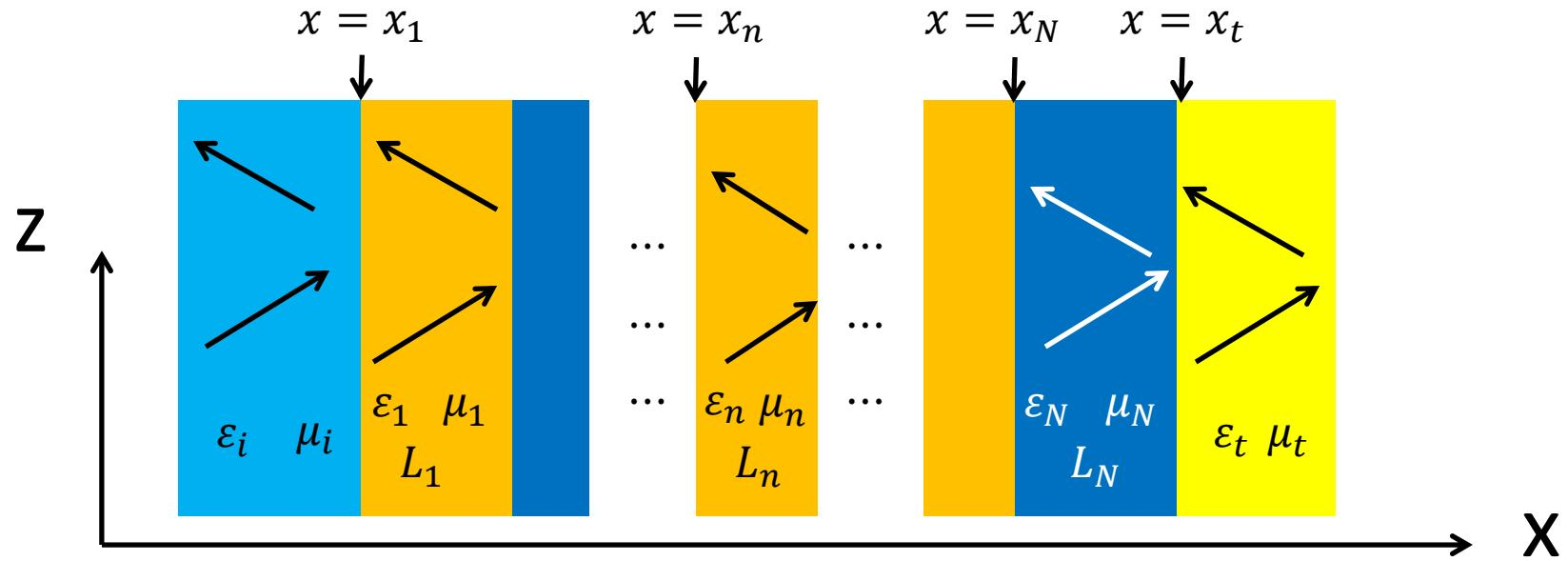
$$\begin{bmatrix} A_t \\ B_t \end{bmatrix} = [(D_t^{TE})^{-1} D_N^{TE} P_N^{TE}] T_{N-1}^{TE} \dots T_n^{TE} \dots T_2^{TE} T_1^{TE} [(D_1^{TE})^{-1} D_i^{TE}] \begin{bmatrix} A_i \\ B_i \end{bmatrix}$$
