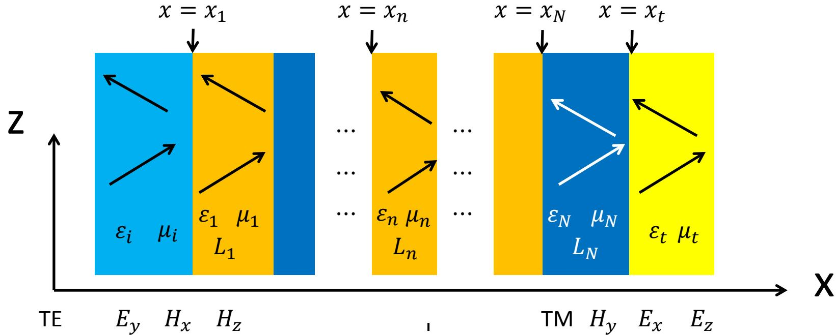
$$\begin{bmatrix} A_{n+1} \\ B_{n+1} \end{bmatrix} = T_n^{TE} \begin{bmatrix} A_n \\ B_n \end{bmatrix} = [D_{n+1}^{TE}]^{-1} D_n^{TE} P_n^{TE} \begin{bmatrix} A_n \\ B_n \end{bmatrix}$$
